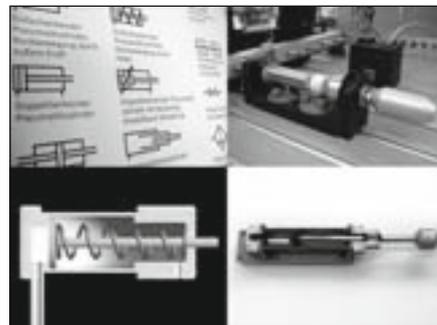
Abb. 5: Darstellungen eines einfach wirkenden Zylinders
